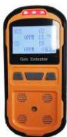
Портативный мультигазовый детектор голосового типа — это устройство безопасности, которое может непрерывно определять концентрацию утекающего газа.
