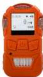
В портативном газоанализаторе K10 для обнаружения газа используется метод естественной диффузии, а в качестве чувствительного элемента — высококачественные газовые сенсоры. Он обладает отличной чувствительностью и повторяемостью, удобен в использовании и обслуживании, что в значительной степени отвечает требованиям безопасности на производстве.
