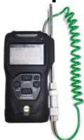
Мультигазовый детектор XP-3318II для ежедневных проверок и обеспечения безопасности на предприятиях, в резервуарах, колодцах и при строительстве тоннелей.
