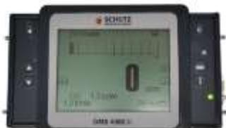
Инновационный прибор GMS 4000 — это универсальное устройство для обнаружения утечек газа, контроля сети и анализа газа. Благодаря технологии инфракрасного измерения, прибор может точно и без перекрестной чувствительности определять природный газ и CO<sub>2</sub>. GMS 4000 обнаруживает тяжелый газ, кислород, сероводород и угарный газ (опциональные датчики). Кроме того, возможен анализ этана/пропана с сохранением данных о результатах измерений.
